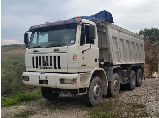
Figura 9. Autocarro da trasporto edile dalle cave di prestito al cantiere
