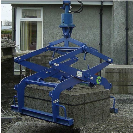
Figura 5. Dispositivo di sollevamento del carico nel cantiere
